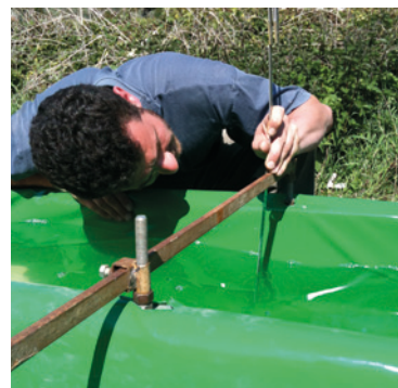
► Figure 5 : Le canal de mesure à l'amont d'une fascine, vue des entretoises et de la bêche
